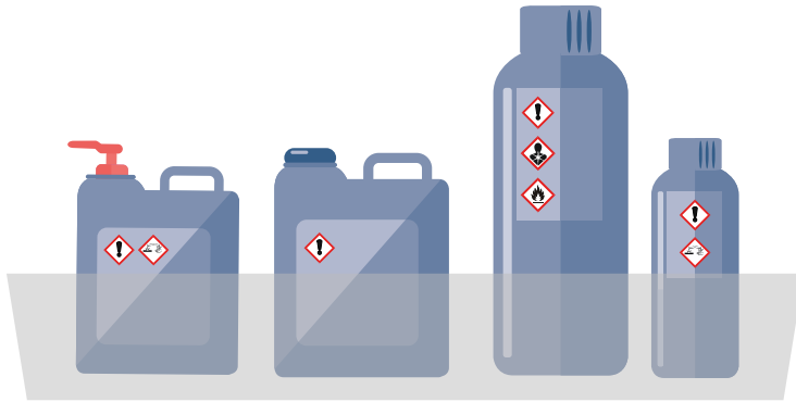
Auffangwanne für Behälter mit flüssigen Gefahrstoffen
